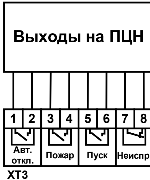
Рисунок 22 – Контакты для подключения выходов на ПЦН.
