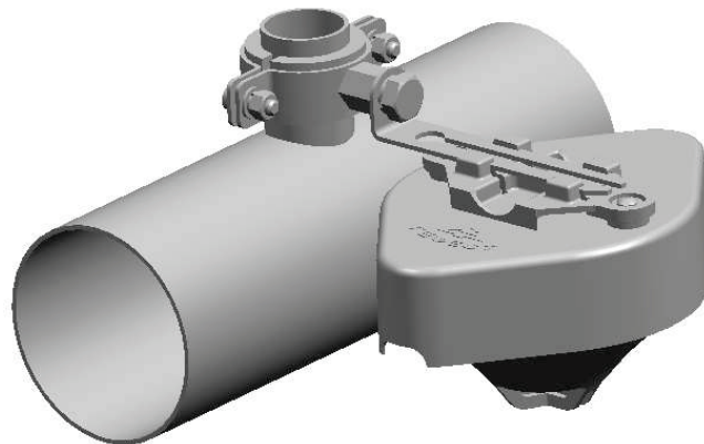
Рисунок 96 – Пример установки ИПТ-СИ-л и МКС-И-л на кронштейн.
